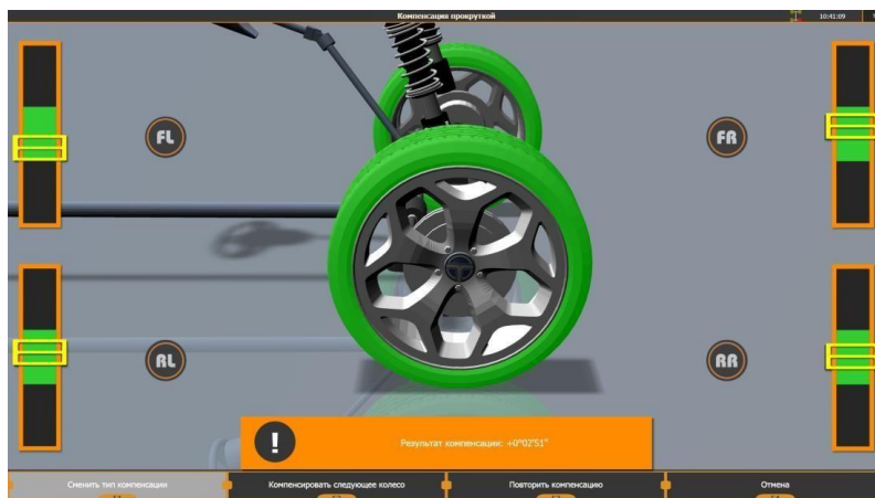
Рисунок 3.29 – Пример результатов компенсации
