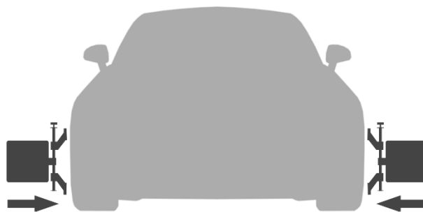
Рисунок 3.21 – Крепление колёсных адаптеров с мишенями
