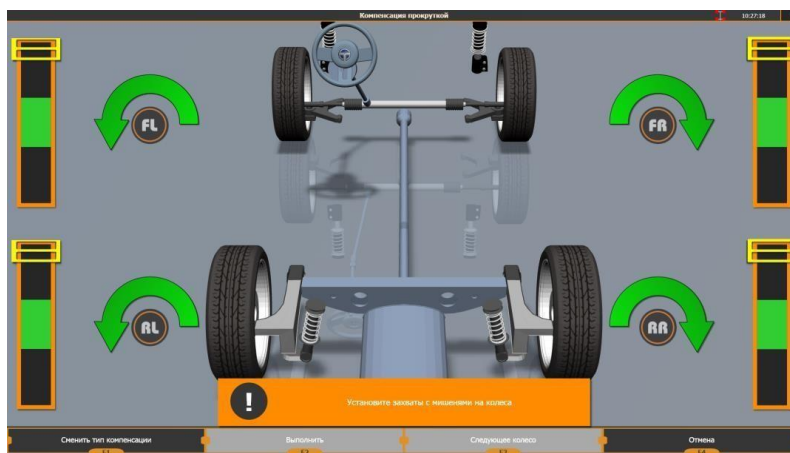
Рисунок 3.25 – Установка мишеней для компенсации прокруткой
